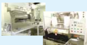
真空・常圧3・6・12・25kg プレスニーダー・ピンミキサー
